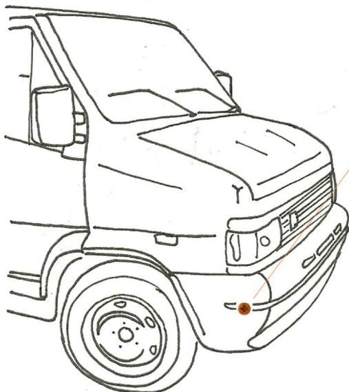
4/ Percer les deux épaisseurs de polyester au niveau du recouvrement de la crosse sur le bandeau central et le viser à l'aide d'une vis dans le creux. (Rep 4 sur les croquis)
